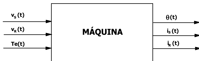
Fig. 1.13 – Representação da máquina elétrica elementar de dois enrolamentos com as variáveis de entrada e saída.
